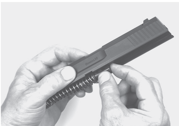
Pufferstange, vollst. einlegen Insert the recoil / buffer spring guide rod Incorporar el dispositivo amortiguador Montage du dispositif amortisseur
