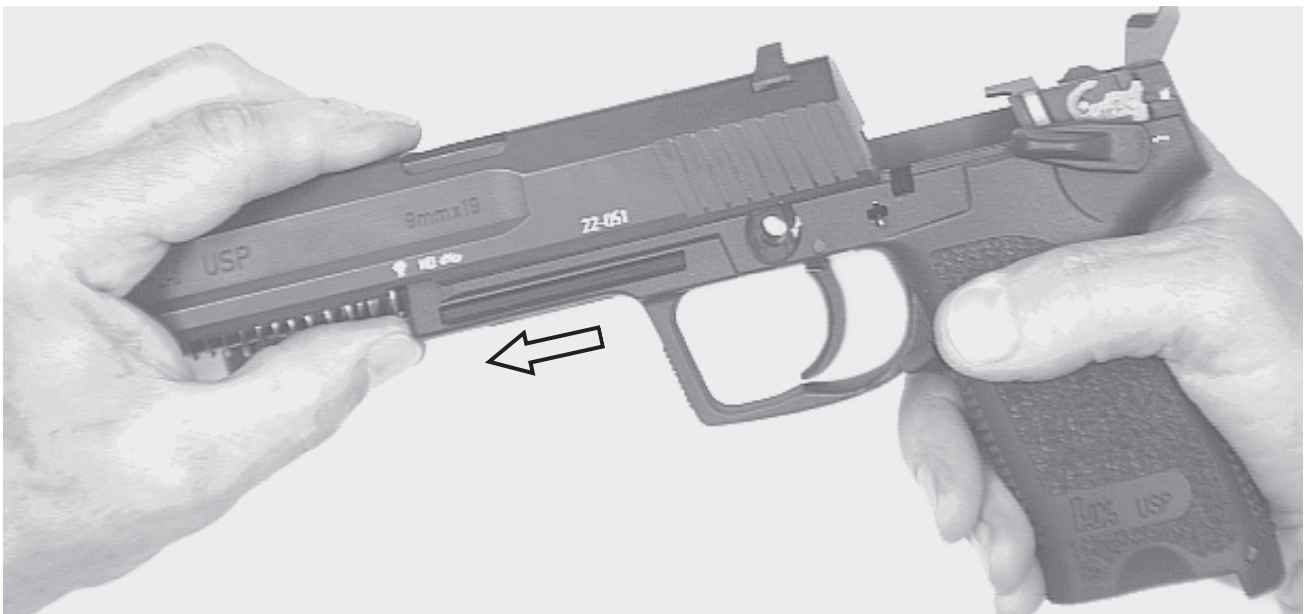
Griffstück einschieben Press in the grip
