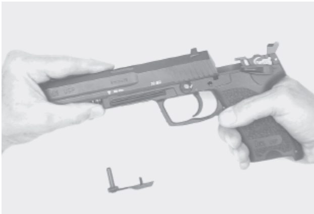
Desprendimiento de la corredera Retirer la glissière
