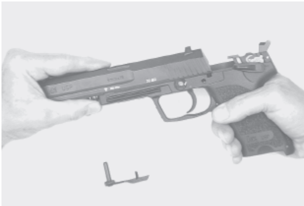
Verschluss abziehen Remove the slide
