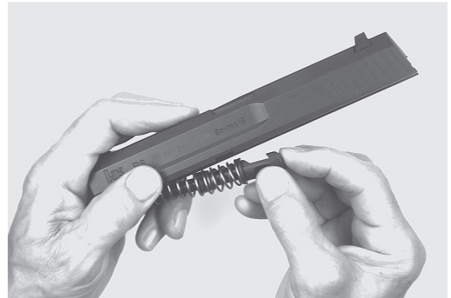
Extracción del dispositivo amortiguador Retirer le dispositif amortisseur
